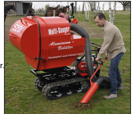
Zamontowany na wózku gąsienicowym
